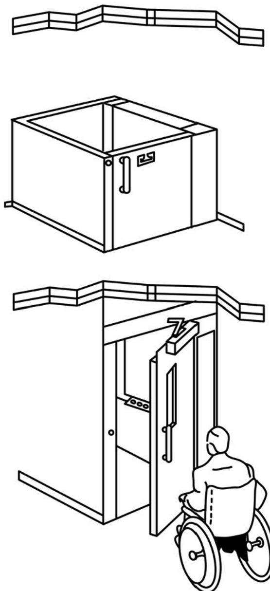
**Figure 5 — Exemple de plate-forme élévatrice verticale avec gaine entièrement close**
